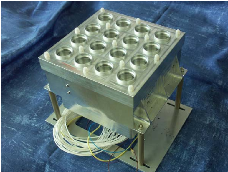
FEEP Thruster mit \mu\text{N} und \text{mN} Schubkraft
