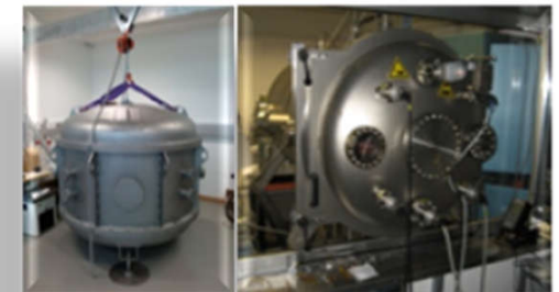
Thermal-Vakuum-Testen und Ausbacken von Komponenten
